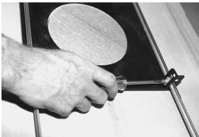
Рис. 8.3: Затягивание крепежных винтов кронштейна
