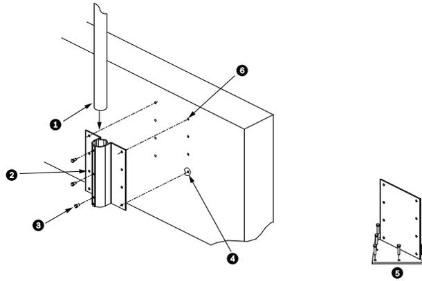
그림 13.1: 난간 벽면 장착 브래킷 및 지붕 장착 플레이트
