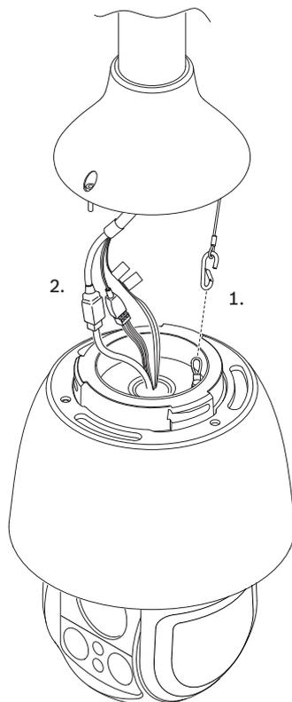
6. Ponga la parte superior de la cámara dentro de la tapa de montaje.
