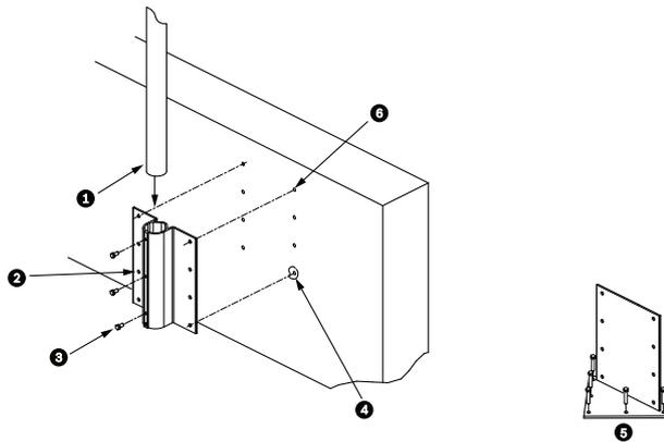
**Figura 8.1: Soporte de sujeción en pared y placa de montaje en azotea**
