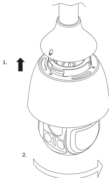
8. Sujete el tornillo de bloqueo de seguridad con el destornillador Torx T15.
