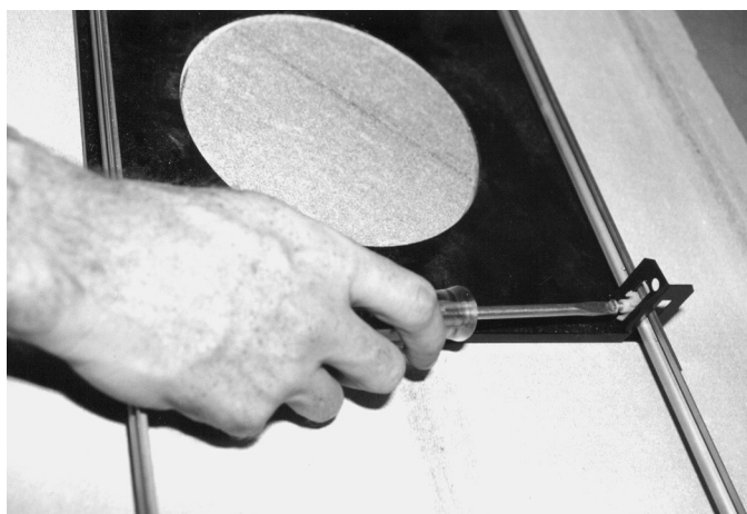
图 9.3: 拧紧支架紧固螺丝
