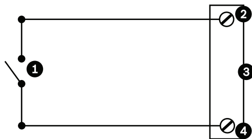
图 11.5: N.C. 常闭不受监测连接
