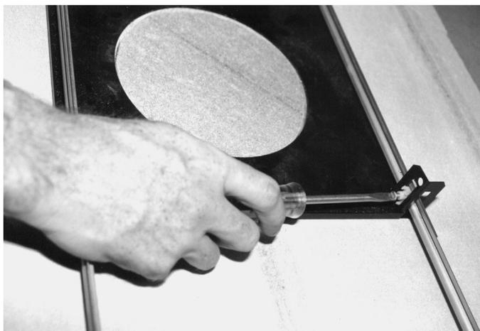
**Figura 9.3: Aperte o parafuso de retenção do suporte**
