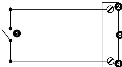
図 11.5: N.C. 常閉-Non-supervised 接続
