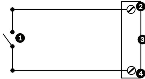
図 11.4: N.O. - 常開-Non-supervised 接続
