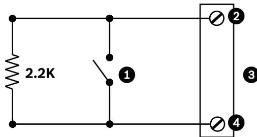
Figure 11.2: N.O.S. - Connexions normalement ouvertes supervisées
