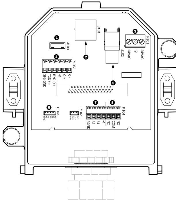
Figure 9.7: Boîtier d'interface pour montage au plafond
