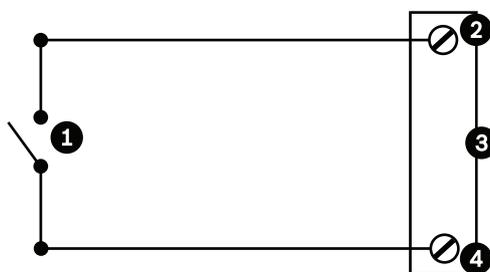
Figure 11.4: N.O. - Connexions normalement ouvertes non supervisées
