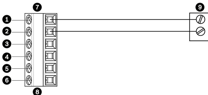
Figure 11.6: Connexion pour audio sur un réseau Ethernet.
