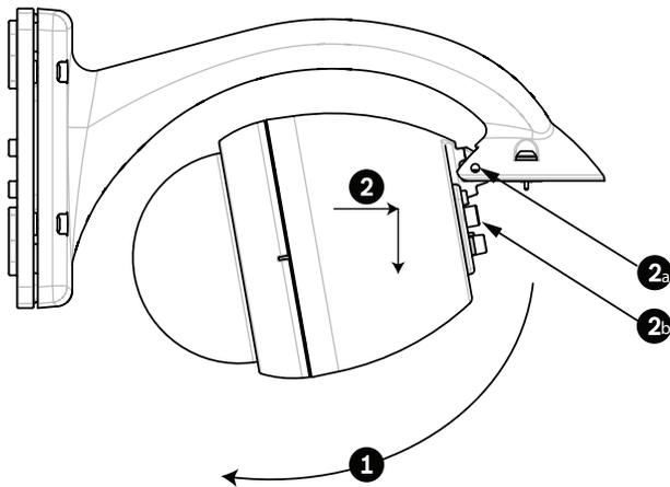
**Figure 7.12: Suspension de la tête au bras**
