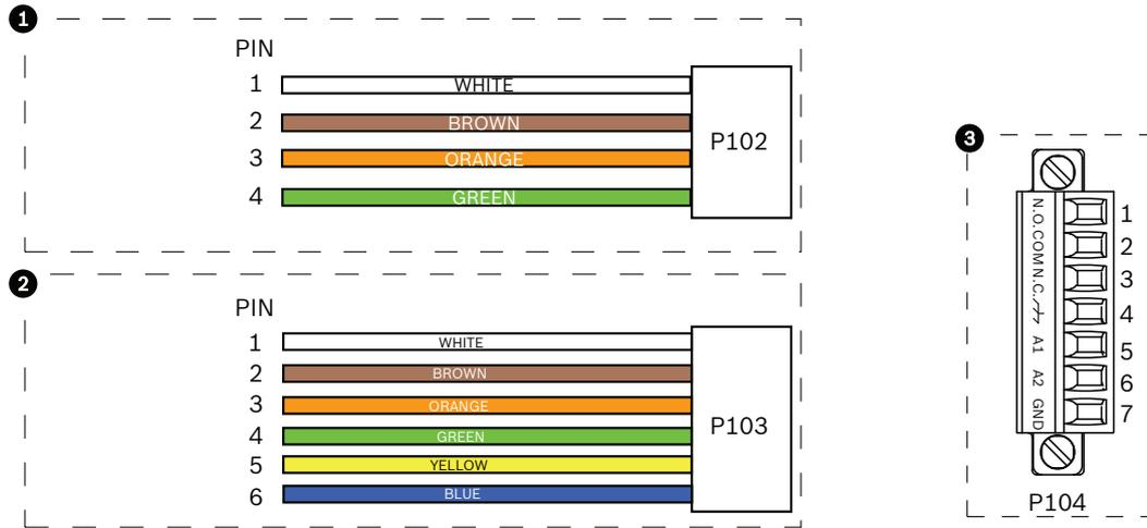
Figure 9.6: Connecteurs d'alarme et de relais
