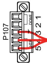
**Figure 7.5: Sortie de l'alimentation 24 Vac**
