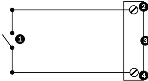
Figure 11.5: N.F. Connexions normalement fermées non supervisées
