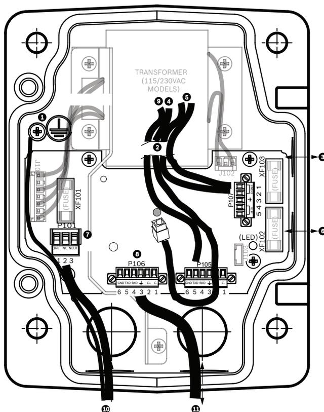
Figure 7.2: Boîtier d'alimentation du bras de suspension
