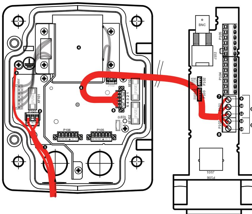
Figure 8.2: Boîtier d'alimentation VG4-A-PSU1 ou VG4-A-PSU2 connecté à la carte d'interface pour tube
