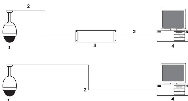
Figure 11.1: Configuration système de l'AUTODOME série 7000
