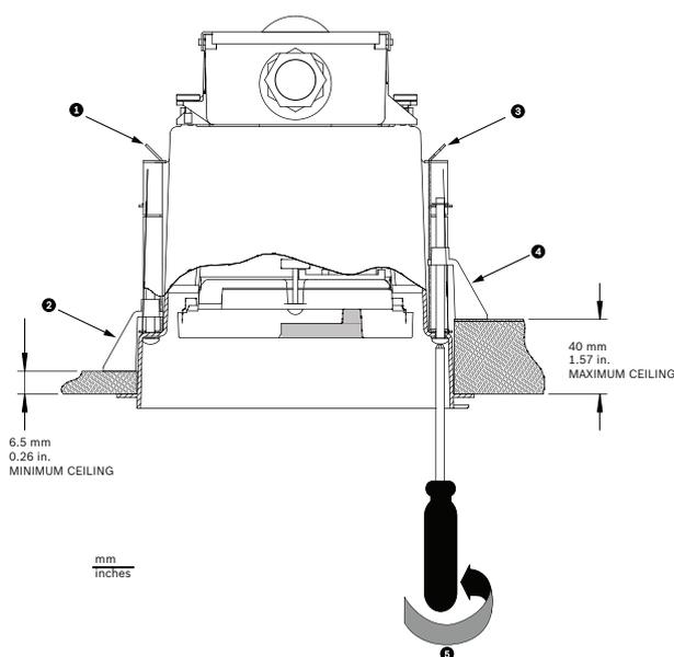
**Figure 9.11: Fixation de la caméra au plafond**
