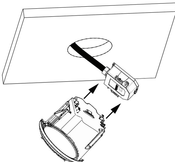
**Figure 9.9: Fixation du boîtier au boîtier d'interface**
