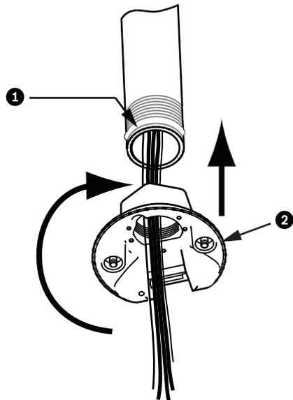
**Figure 8.9: Fixation de la calotte du dôme**
