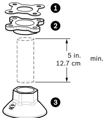
**Figure 8.10: Montage sur tube**
