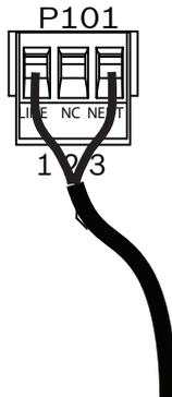
**Figure 7.4: Arrivée de l'alimentation électrique 115/230 Vac**
