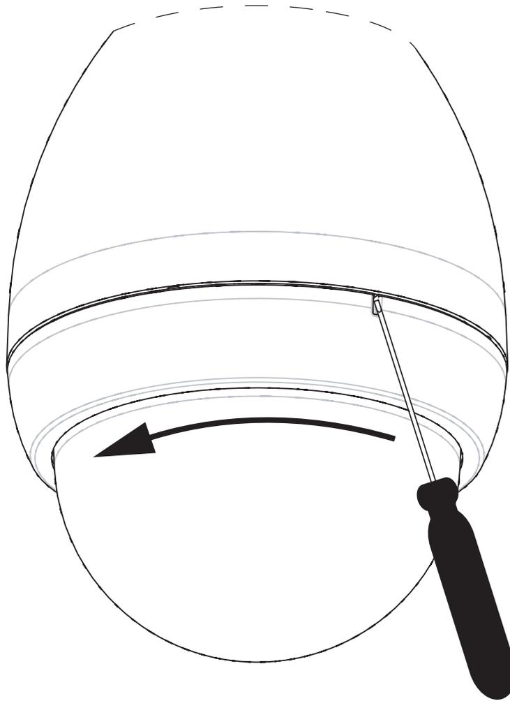
**Figure 10.2: Rainure de déverrouillage de la sphère**
