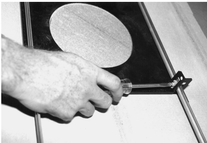
Figura 9.3: Fijación de los tornillos de seguridad al soporte
