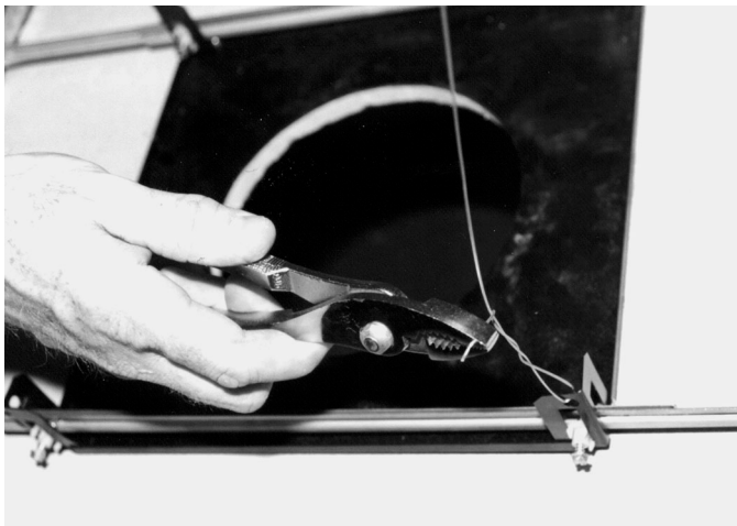
Figura 9.4: Sujeción del conjunto de soporte
