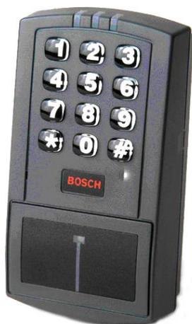
Das Zutrittskontrollterminal ARD-EntryProx ermöglicht den autarken Zutritt mit Karte und/oder PIN-Code. Es kann eine Tür steuern. Der Anschluss über Wiegandschnittstelle an eine Zutrittskontrollzentrale ist möglich.
