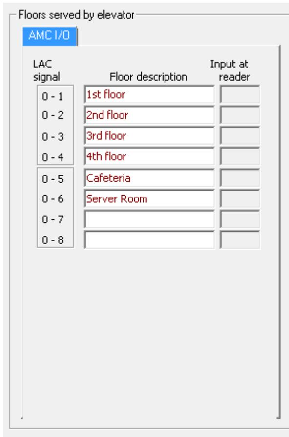
标准而言，一个AMC2可用于8个楼层。在以下前提下，可以连接多个入口：
