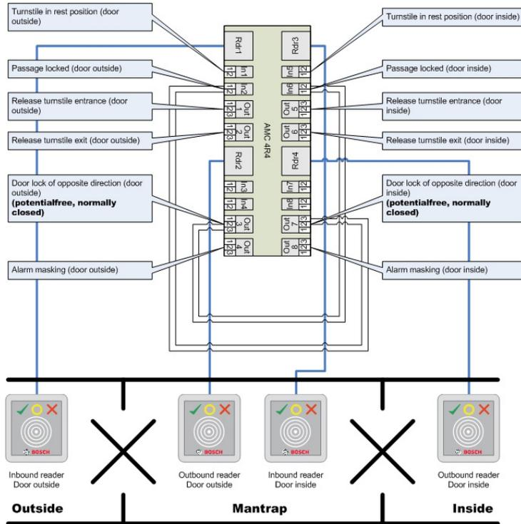
与反方向门锁的连接可以确保每次仅打开两个十字转门中的一个。
