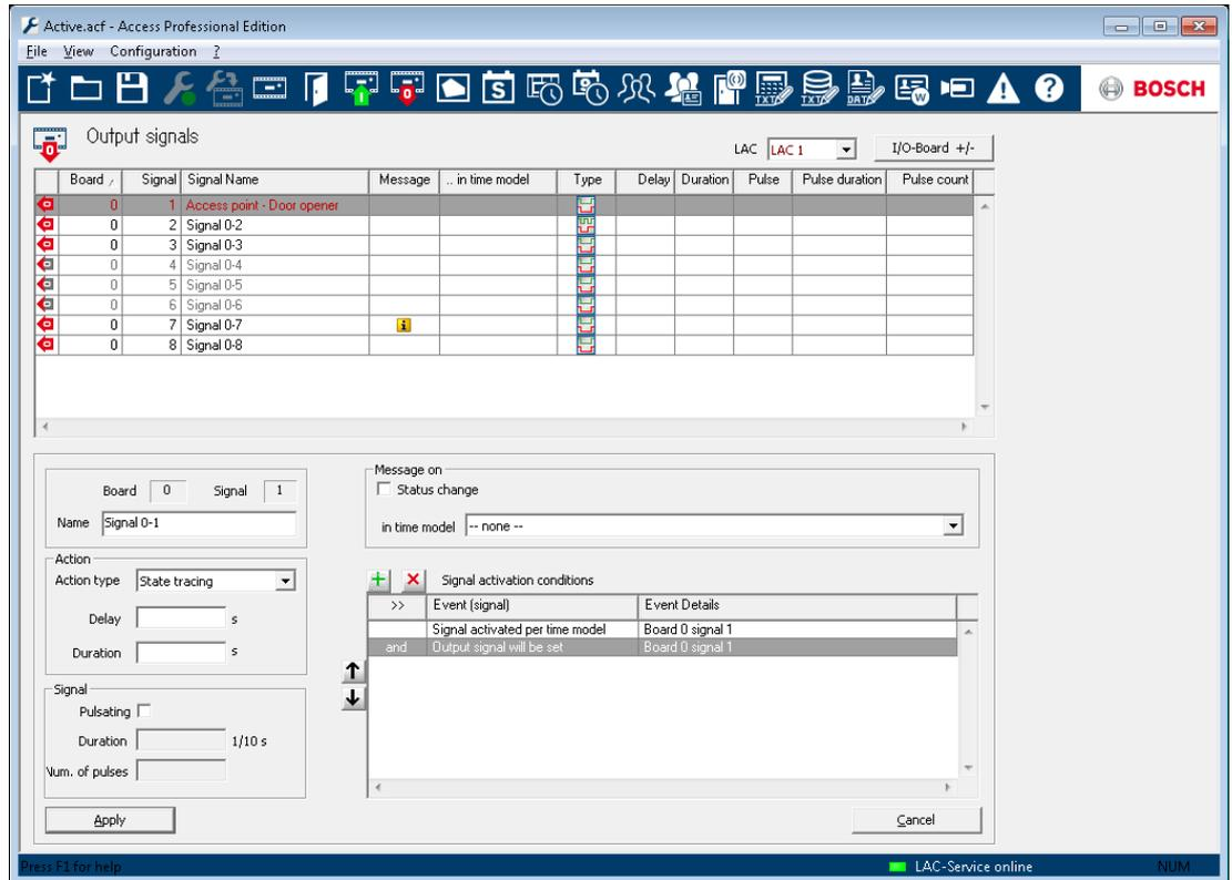
在打开此对话框时，始终显示第一个控制器。请使用组合框 LAC 和连续编号方案来选择所需的控制器。标准控制器定义流程将创建 8 个输入信号和 8 个输出信号。如果控制器能够处理更多的信号，您可以使用 I/O boards +/- (I/O 板 +/-) 按钮创建其它信号。所有定义的信号均显示在列表中。每个信号的设置显示在列表的不同列中，并显示在列表下方选定信号的参数控制中。所有设置全部通过列表及列表下面的参数控制来进行，如下表所述。除了此处介绍的设置外，还可以定义为了激活输出信号而必须满足的其它条件。
