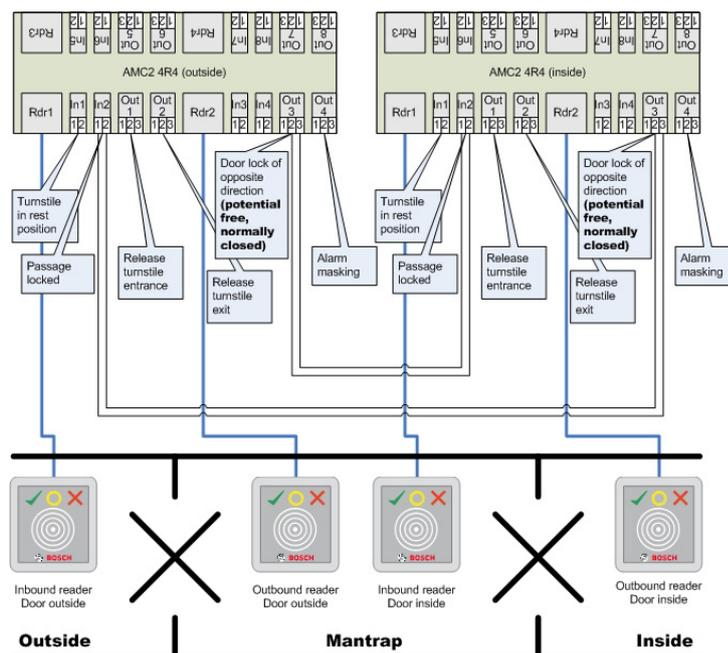
与反方向门锁的连接可以确保每次仅打开两个十字转门中的一个。
