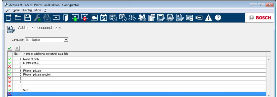
列表框中已经包含 10 个供您使用的行。通过双击 **Name of additional personnel data field** ( 附加人员数据字段的名称 ) 列中的字段，您可以使该字段处于可编辑状态，并可为它输入一个名称。
