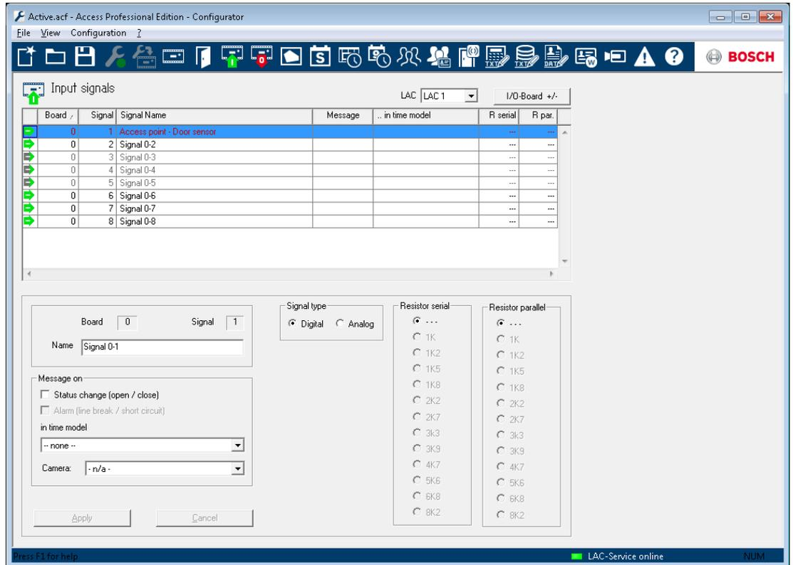
在打开此对话时，始终显示第一个控制器。请使用组合框 **LAC** 和连续编号方案来选择所需的控制器。标准控制器定义流程将创建 8 个输入信号和 8 个输出信号。如果控制器能够处理更多的信号，您可以使用 **I/O boards +/-** (I/O 板 +/-) 按钮创建其它信号。所有定义的信号均显示在列表中。每个信号的设置显示在列表的不同列中，并显示在列表下方选定信号的参数控制中。所有设置全部通过列表及列表下面的参数控制来进行，如下表所述。
