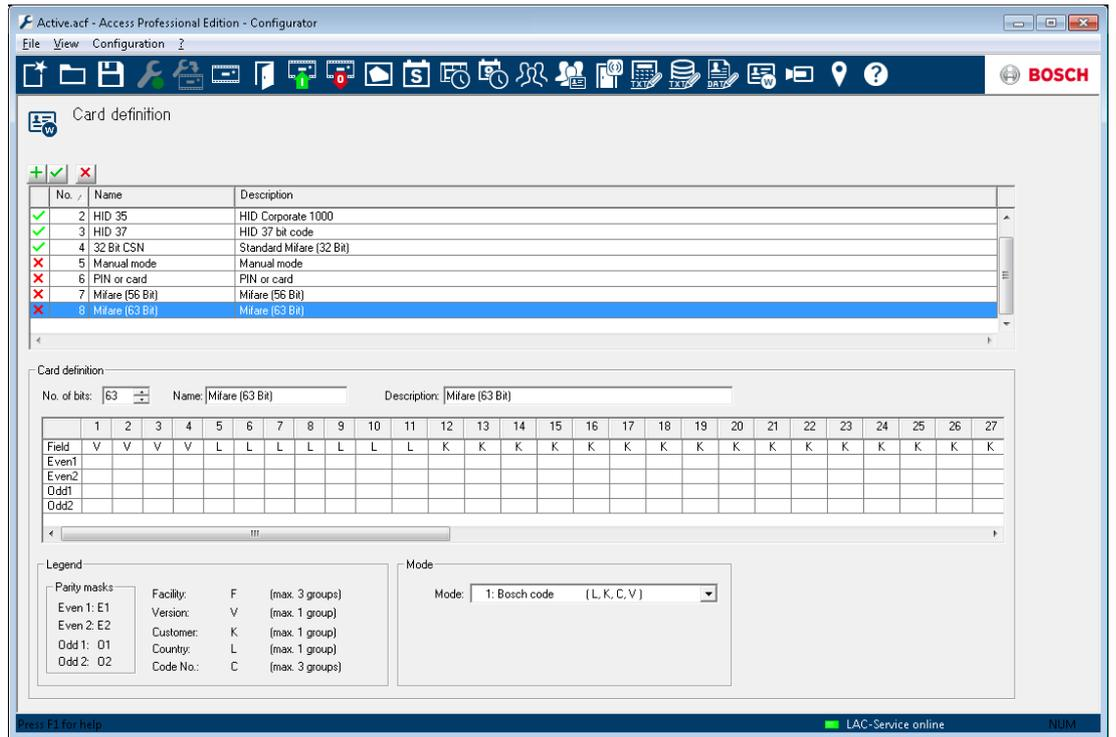
列表控制包含现有证卡定义。默认系统设置包含6个标准条目，其中前4个已激活（第一列中带绿色勾号标记）。除了输入模式设置外，所有其他设置均启用了写保护功能，不能修改或删除。
