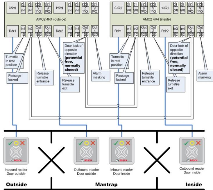
Verbindungen zu den Türverriegelungen für die Gegenrichtung gewährleisten, dass jeweils nur eines der Drehkreuze geöffnet werden kann.
