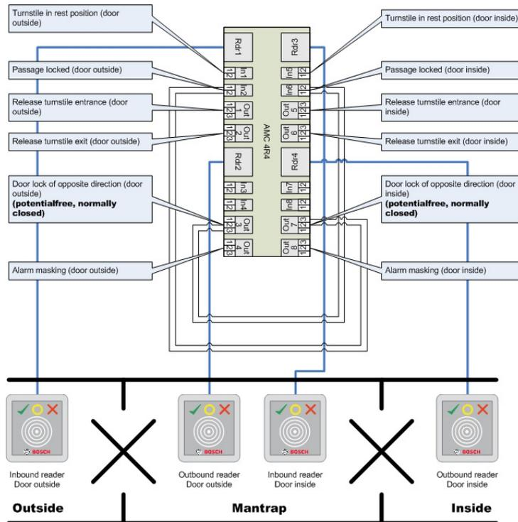
Verbindungen zu den Türverriegelungen für die Gegenrichtung gewährleisten, dass jeweils nur eines der Drehkreuze geöffnet werden kann.
