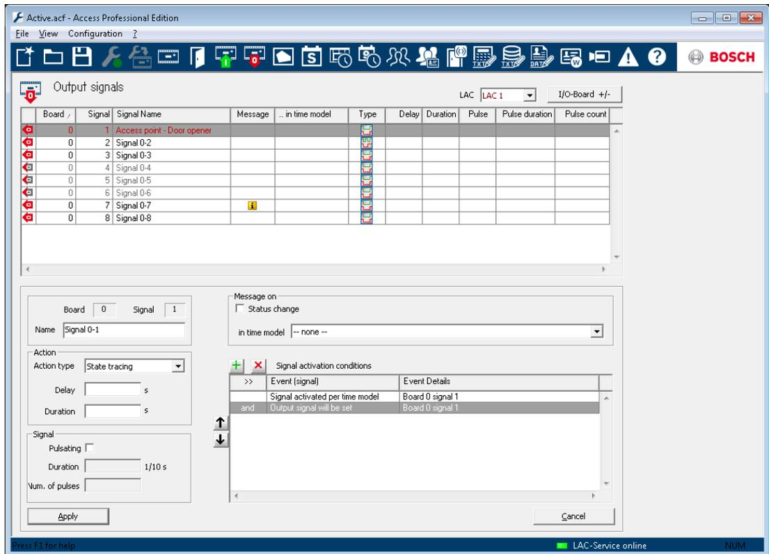
Bei Aufruf dieses Dialoges wird immer der erste Controller angezeigt. Wählen Sie den gewünschten Controller über die Auswahlliste **LAC** anhand der fortlaufenden Nummerierung aus. Bei der Standardeinrichtung eines Controllers werden 8 Eingangs- und 8 Ausgangssignale angelegt. Verfügt der verwendete Controller über mehr als diese 8 Kontakte, können über die Schaltfläche **I/O Platine +/-** weitere Signale aktiviert werden.
