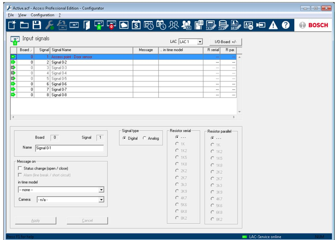
Bei Aufruf dieses Dialoges wird immer der erste Controller angezeigt. Wählen Sie den gewünschten Controller in der Auswahlliste **LAC** anhand der fortlaufenden Nummerierung aus. Bei der Standardeinrichtung eines Controllers werden 8 Eingangs- und 8 Ausgangssignale angelegt. Verfügt der verwendete Controller über mehr als diese 8 Kontakte, können über die Schaltfläche **I/O Platine +/-** weitere Signale aktiviert werden.
