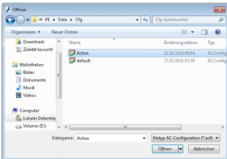
Если требуется внесение изменений или расширение существующей конфигурации для последующей активации, пользователь может открыть базовую конфигурацию, изменить ее и сохранить под другим именем. Таким образом, возможно многократное использование и расширение предыдущих конфигураций, при этом не требуется каждый раз начинать с базовых настроек в **default.acf**.
