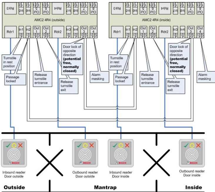
Les connexions aux verrouillages de porte pour la direction opposée garantissent l'ouverture d'un seul tourniquet à la fois.
