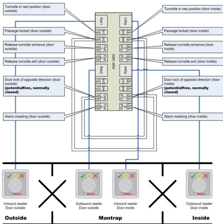
Les connexions aux verrouillages de porte pour la direction opposée garantissent l'ouverture d'un seul tourniquet à la fois.
