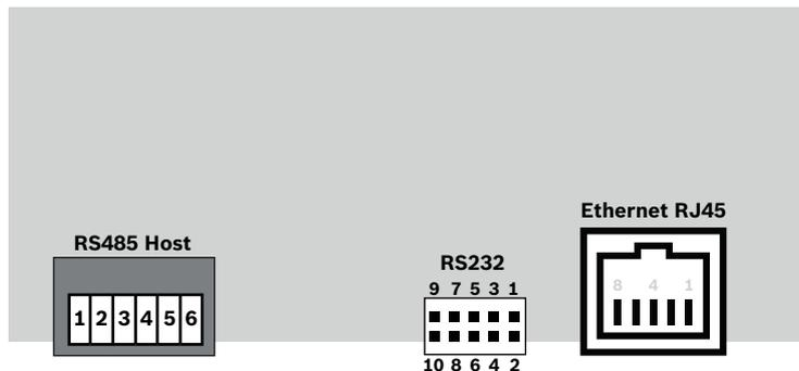
**Figura 11.1:** Conectores na PCB superior
