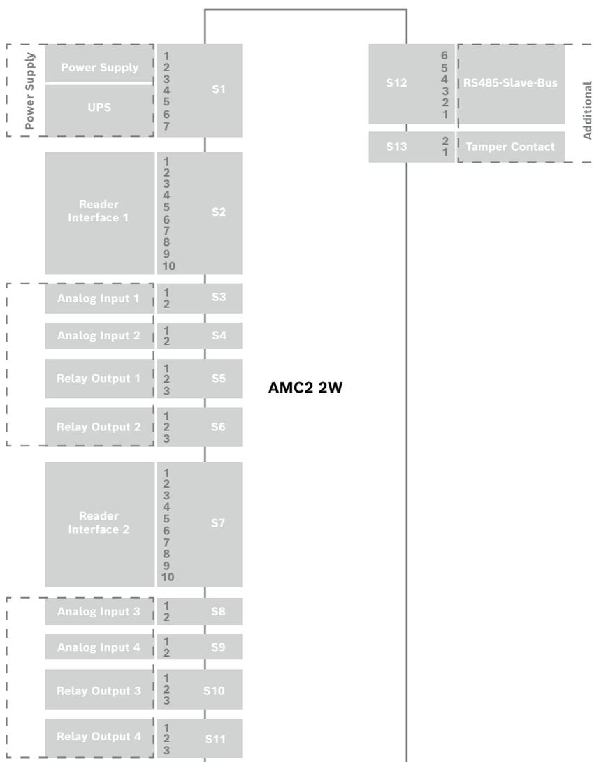
Figura 11.3: Blocos de conectores do AMC2-2W
