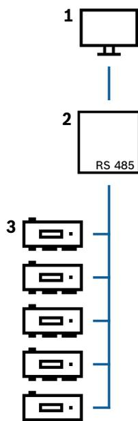
**Figura 4.9:** Configuração de um sistema host RS-485
