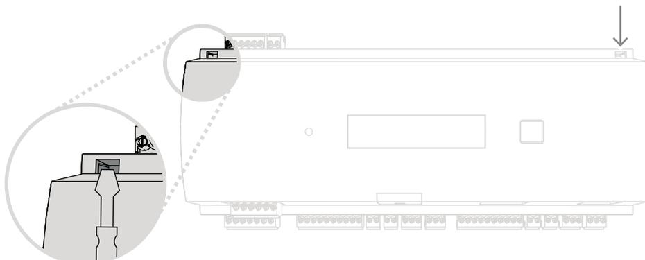
**Figura 4.3:** Abrindo a caixa do controlador
