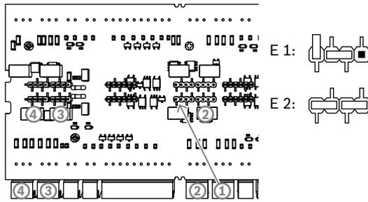
**Figura 4.20:** Localização dos jumpers da saída de relé (lado inferior)
