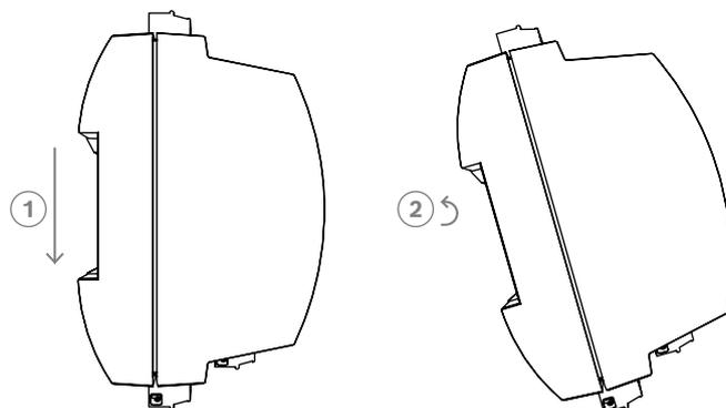
**Figura 4.2:** Desmontar o controlador do trilho de montagem
