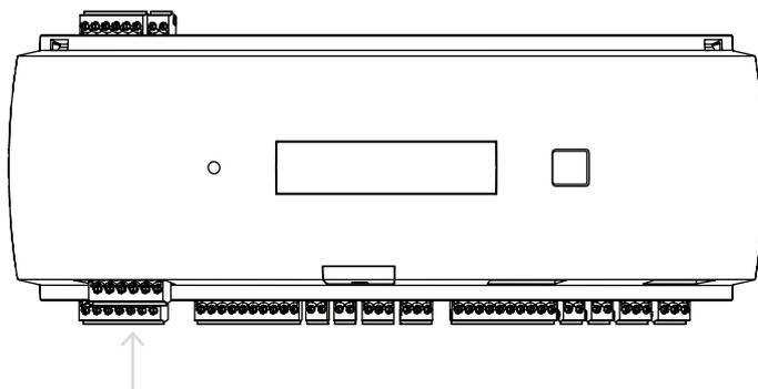
**Figura 4.7:** Localização do conector de fonte de alimentação
