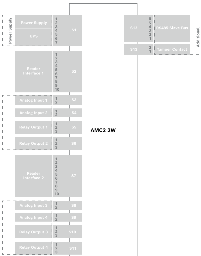
Rysunek 11.3: Schemat blokowy złączy modułu AMC2-2W
