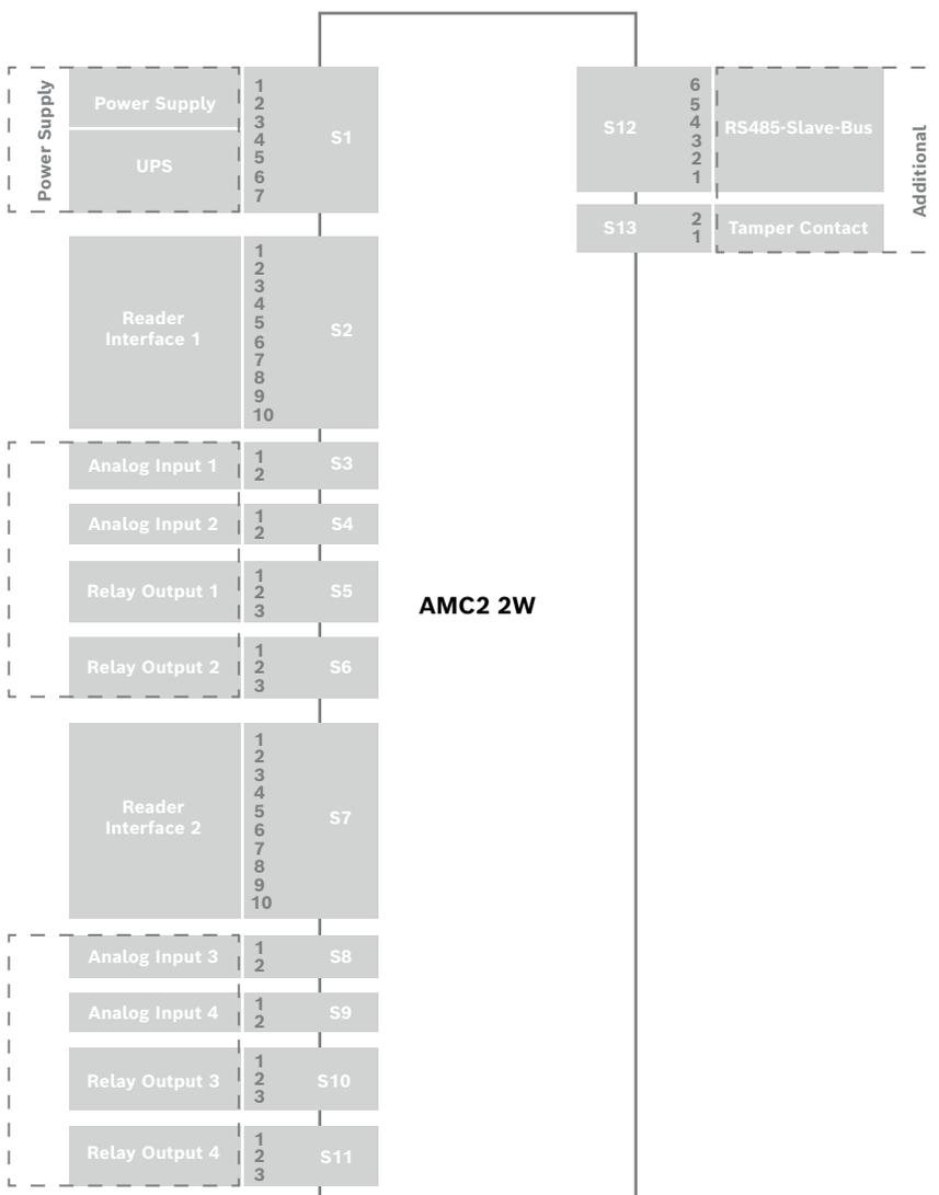
Figure 11.3: Borniers de l'AMC2-2W
