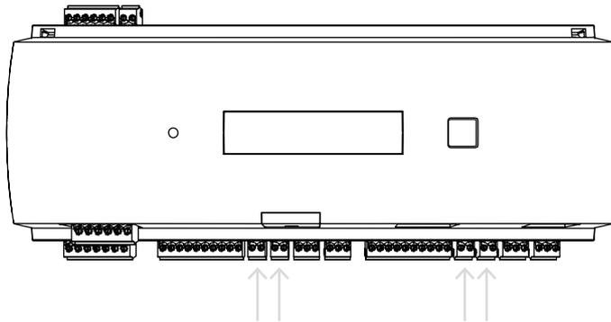
**Figure 4.21:** Emplacement des connecteurs d'entrée analogique
