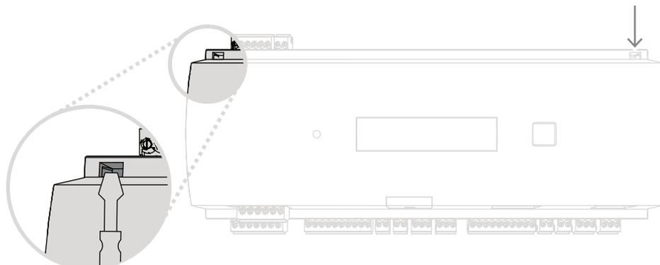
**Figure 4.3:** Ouverture du boîtier du contrôleur
