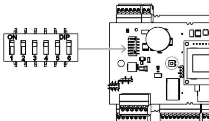
**Figure 4.13:** Emplacement du sélecteur des paramètres hôte
