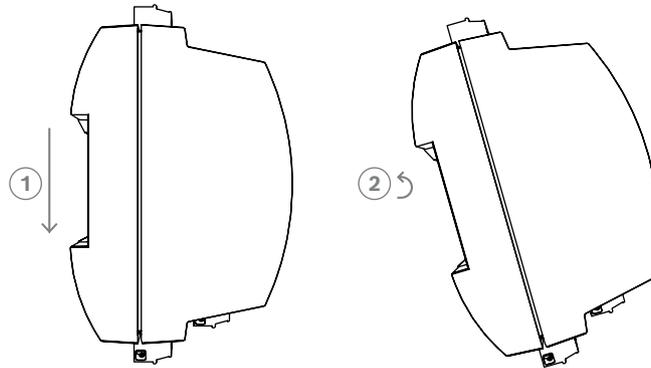
**Figure 4.2:** Démontage du contrôleur d'un rail de montage
