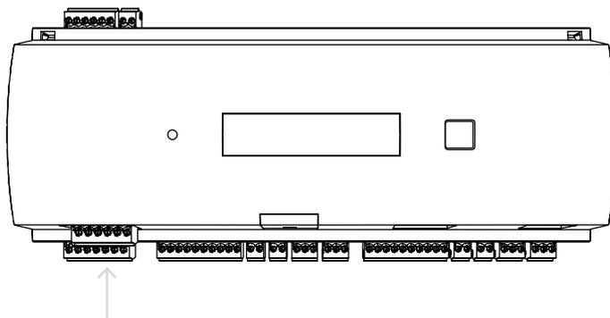
**Figure 4.7:** Emplacement du connecteur d'alimentation
