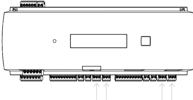
**Figure 4.17:** Emplacement des connecteurs de sorties de relais
