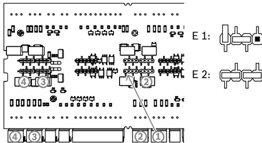
**Figure 4.20:** Emplacement des cavaliers de sorties de relais (face inférieure)
