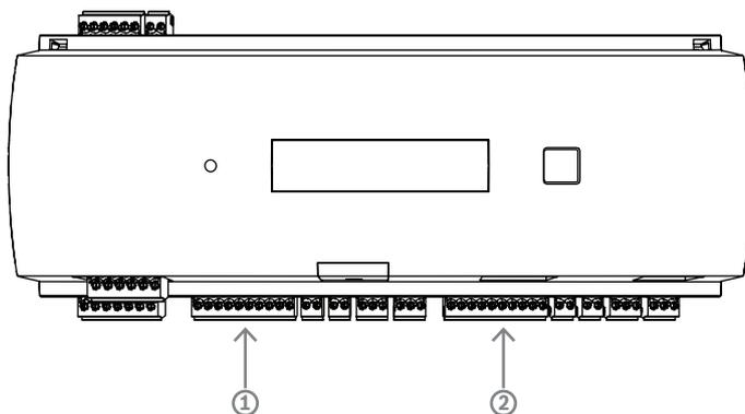
Figure 4.16: Emplacement de l'interface Wiegand (port) pour les lecteurs
