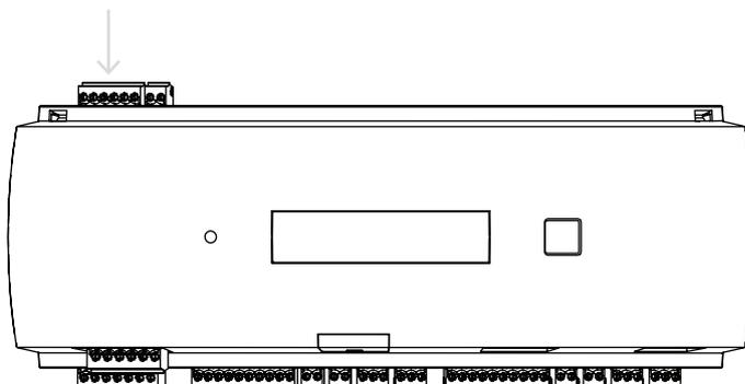
**Figure 4.14:** Emplacement du bus du module d'extension RS-485
