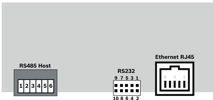
**Figure 11.1:** Connecteurs sur la carte PCB supérieure
