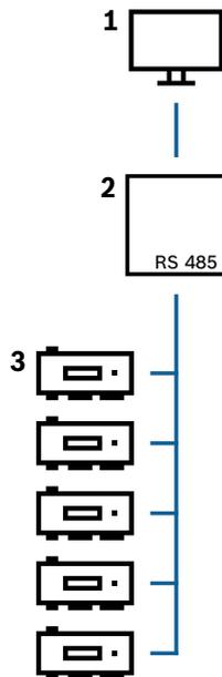
Figure 4.9: Configuration d'un système hôte RS-485
