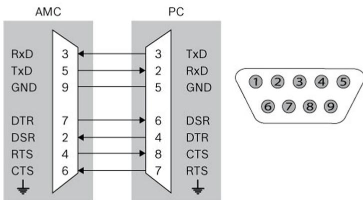
Figure 11.2: Schéma d'interconnexion de l'interface spécifique au projet
