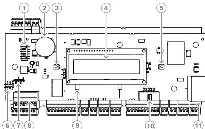
Figure 3.3: Carte à circuits supérieure avec affichage (avant)
