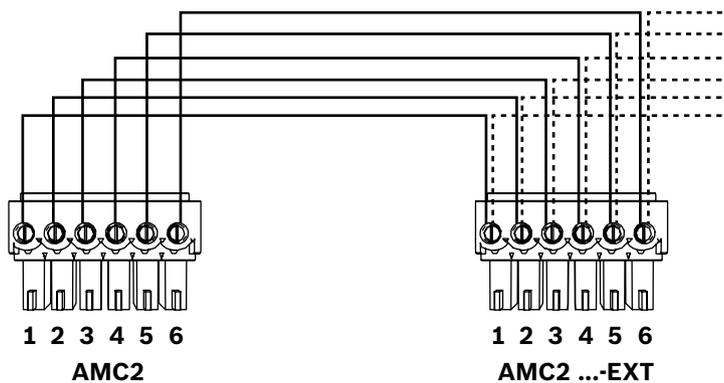
Figure 4.15: Connexion d'un module d'extension à un contrôleur
