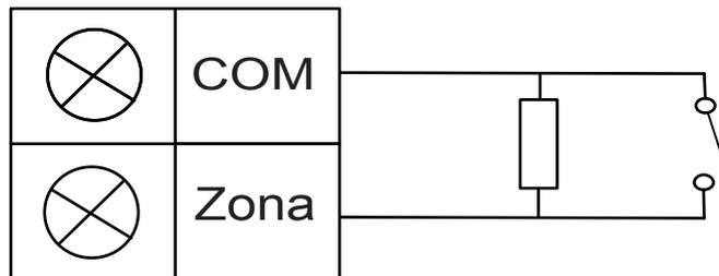
La centrale di controllo imposta cortocircuito/aperto come attivato in caso di collegamento con singolo EOL.
