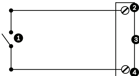
Figura 13.4: N.A. - Conexiones no supervisadas normalmente abiertas
