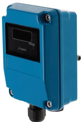
Detektori otvorenog plamena upotrebljavaju se za detekciju otvorenog plamena u zatvorenim i otvorenim prostorima. Reagiraju na svjetlo koje plamen emitira tijekom izgaranja. Detektori plamena posebno su prikladni za bezdimne požare tekućina i plinova nevidljive golim okom, kao i za požare materijala koji sadrže ugljik i stvaraju snažan dim.
